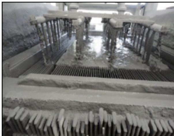
Figura 12. Polpa abrasiva sendo despejada sobre o processo de corte.
