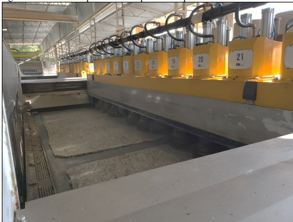
Figura 17. Politriz do tipo automática polindo chapas de rochas ornamentais.
