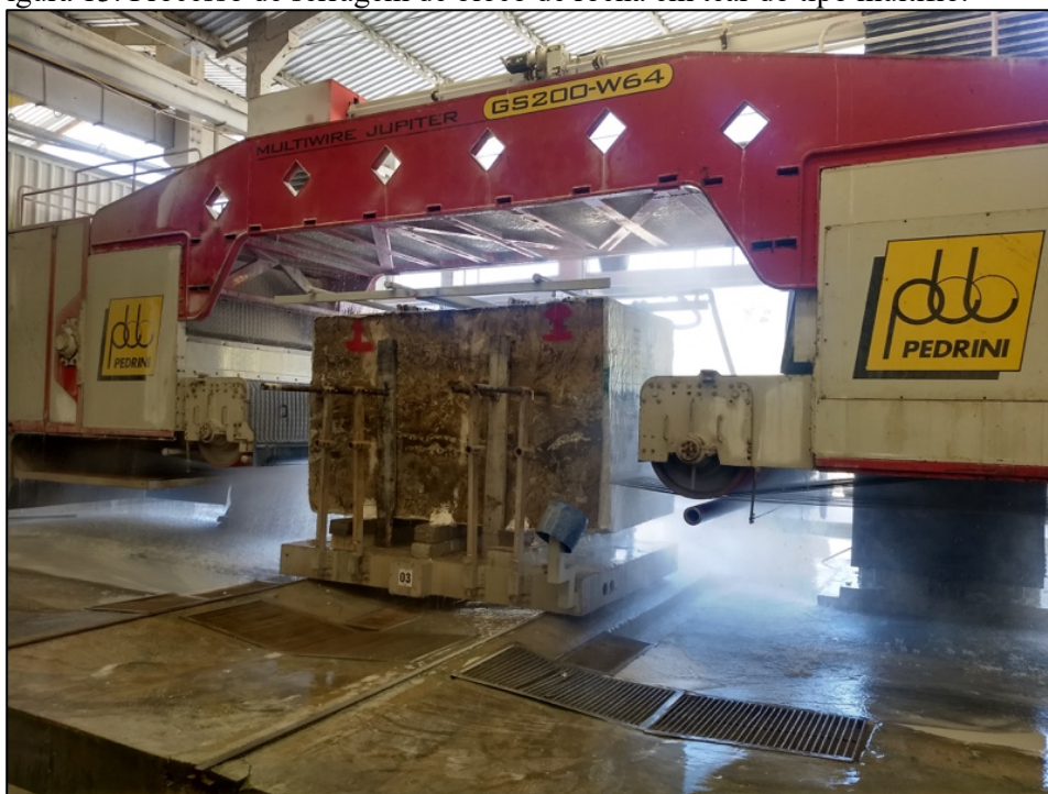
Figura 13. Processo de serragem de bloco de rocha em tear do tipo multifio.
