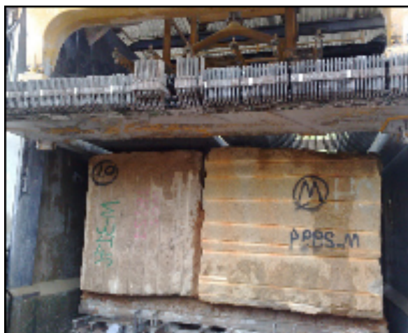
Figura 11. Serragem dos blocos de rocha em tear multilâmina.
