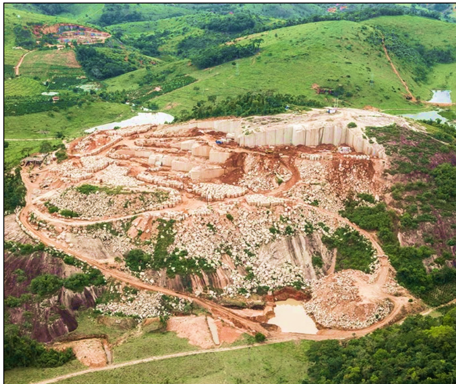
Figura 8. Lavra de rochas ornamentais no norte do Espírito Santo. Detalhe para grande geração de resíduo grosso.
