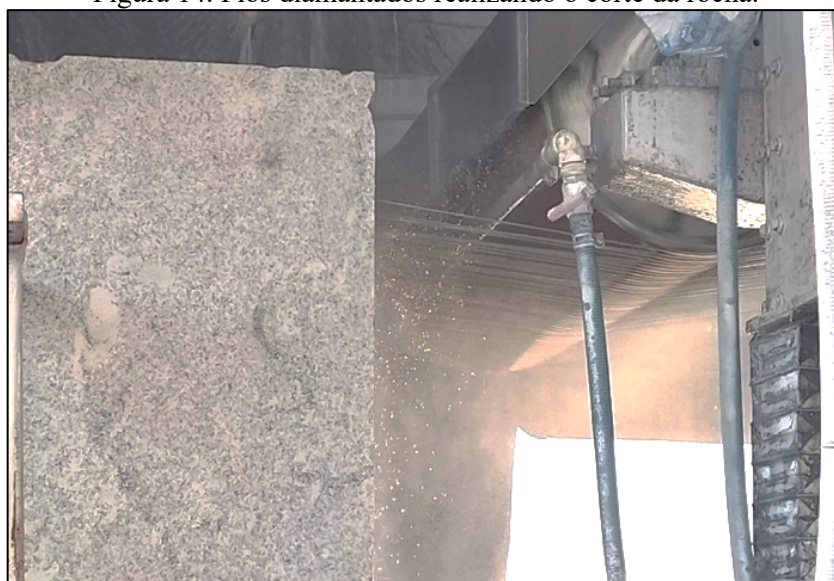
Figura 14. Fios diamantados realizando o corte da rocha.
