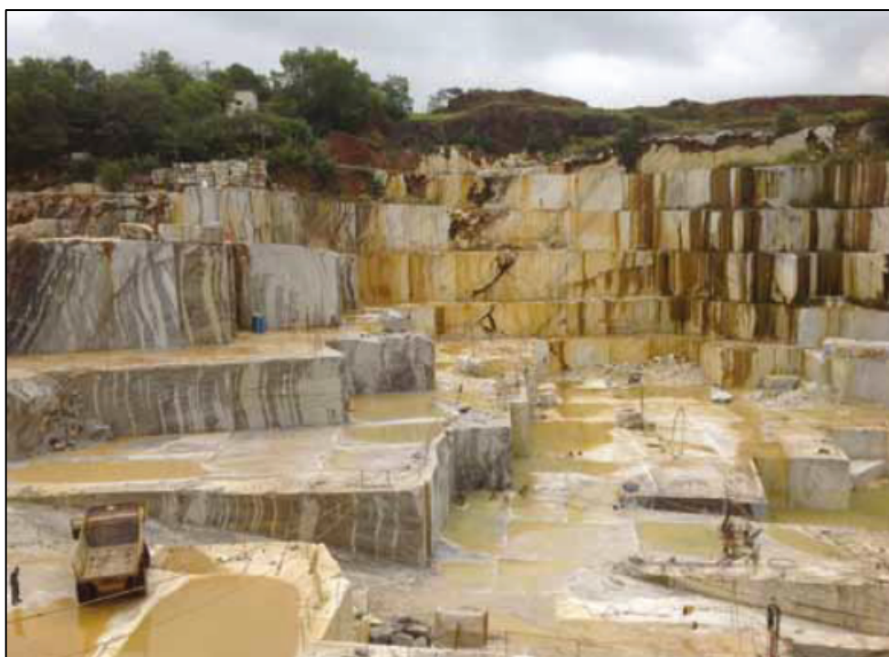
Figura 6. Lavra de maciço rochoso desenvolvida em bancadas.
